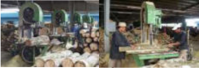
Hình 1.1. Cưa vanh dùng để xẻ phá gỗ tròn thành ván
