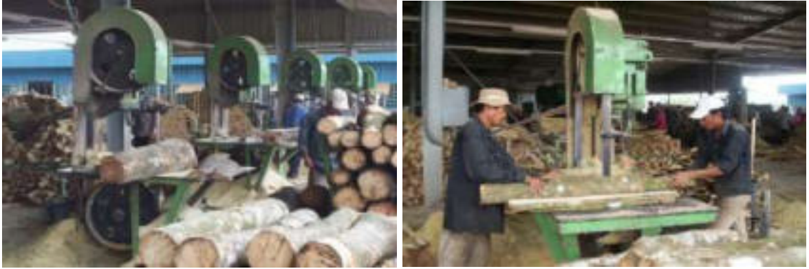
Hình 1.6. Cưa vanh dùng để xẻ phá gỗ tròn thành ván
