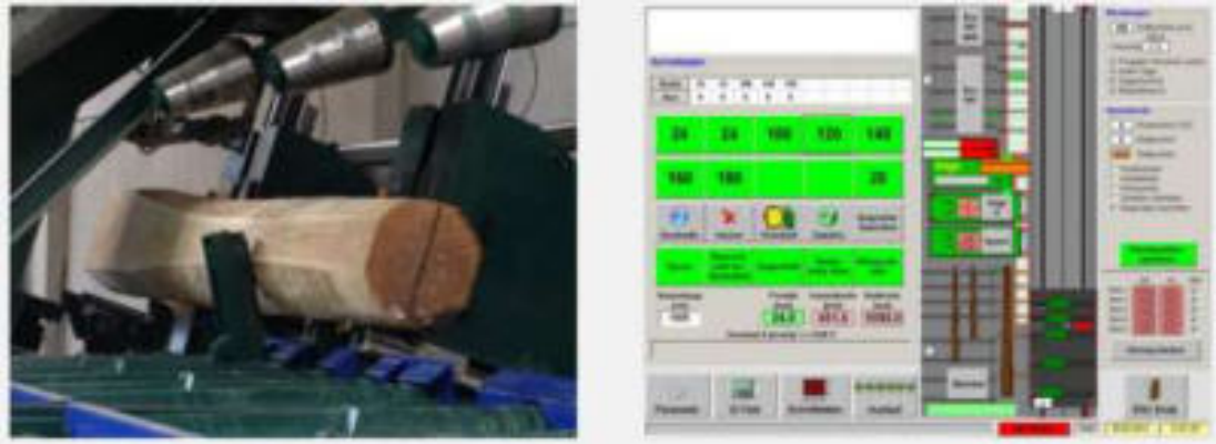
Hình 1.2. Tay máy xoay trở gỗ và giao diện HMI của hãng sản xuất Möhringer
