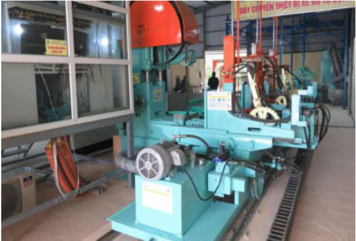
Hình 1.10. Dây chuyền xẻ gỗ do đề tài ĐTĐL.CN-10/16 chế tạo
