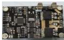
Hình 2.13: Bộ điều khiển động cơ DC thông minh DRIVER PID SMART MOTOR DC
