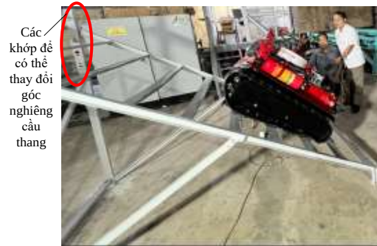
Hình 4.2: Cầu thang thực nghiệm với các khớp được chế tạo để thay đổi góc nghiêng
