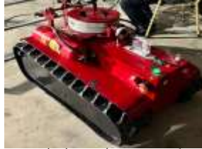
c) Cảm biến gắn trên nắp xe robot tại điểm có mặt phẳng nằm ngang
