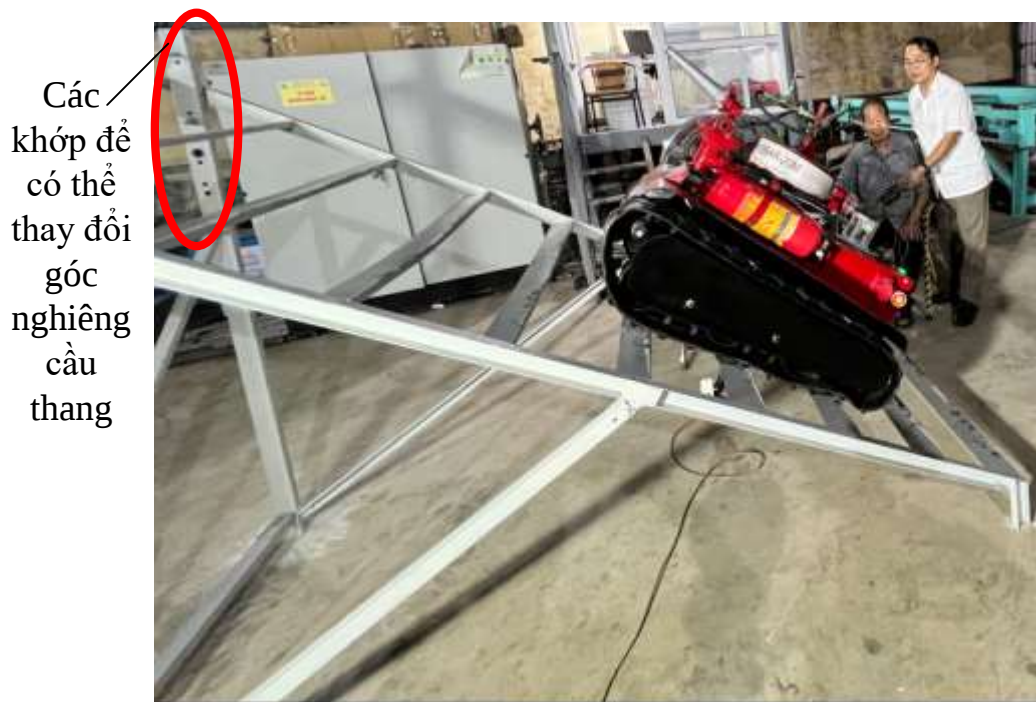
Hình 4.2: Cầu thang thực nghiệm với các khớp được chế tạo để thay đổi góc nghiêng
