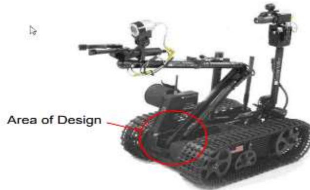
Hình 1.7: Cánh tay robot được tính toán thiết kế [22]
