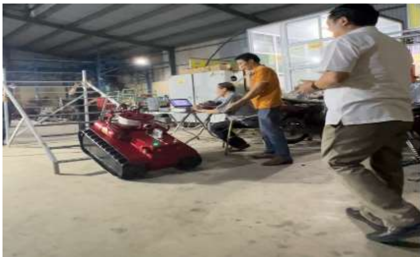
Hình 4.8: Tổ chức thí nghiệm và đo kết quả với cầu thang chế tạo có khả năng thay đổi độ dốc
