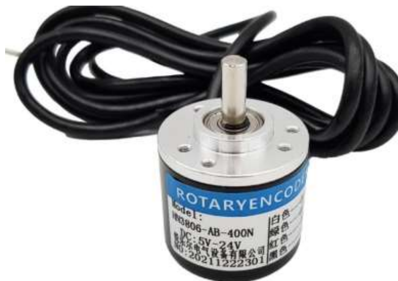
Hình 4.4: Encoder phát xung để đo vận tốc và gia tốc góc
