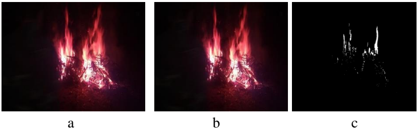
Hình 3.11. Sự phát hiện của khói màu lửa thử nghiệm; (a, b) khung hình liên tiếp; (b) hình ảnh sau xử lý.
