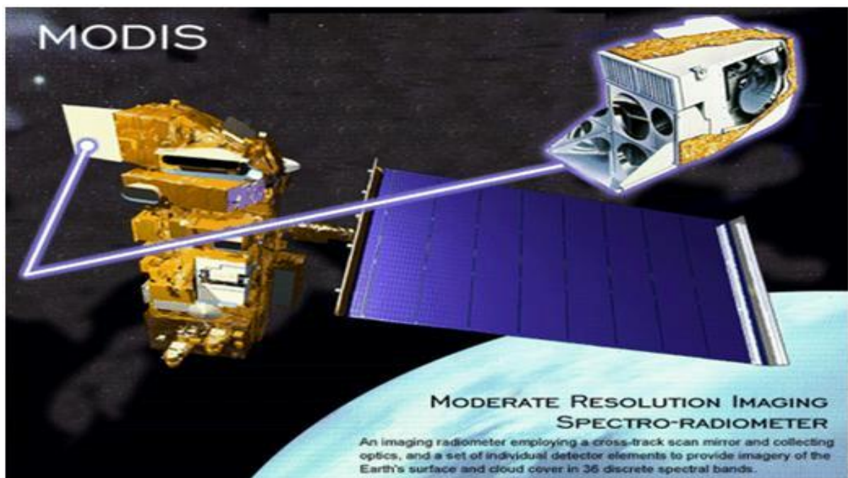
Hình 3.2. Cảm biến MODIS được gắn trên vệ tinh Terra và Aqua (Nguồn: https://modis.gsfc.nasa.gov/gallery/ )
