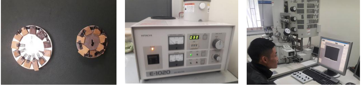
Hình 1.15. Mẫu gỗ và thiết bị chụp ảnh SEM
