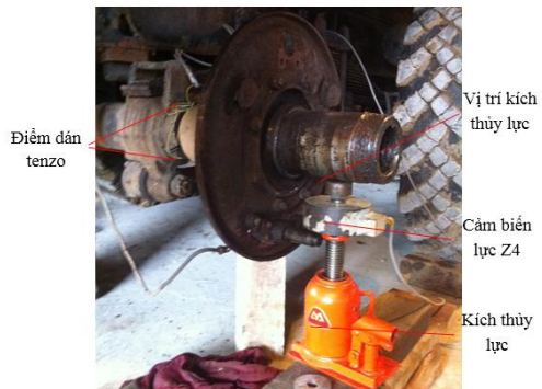
Hình 4.11: Hiệu chuẩn giá trị đo phản lực pháp tuyến
