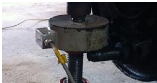
Hình 4.9: Gắn cảm biến lực Z4 để hiệu chuẩn
