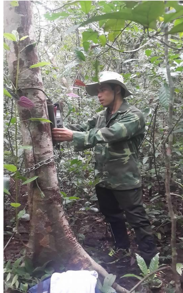
Lắp đặt máy ghi âm tự động SM3 (Wildlife Acoustics Inc.)
