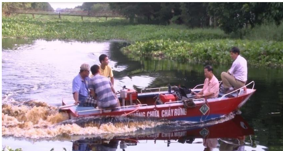
Hình 4.3. Thí nghiệm đo góc nghiêng khi xuồng quay vòng với góc lái lớn nhất
