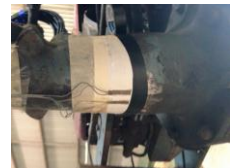
Hình vẽ 4.20. Sơ đồ mạch đo và phương pháp dán ten rô điện trở lên vỏ cầu
