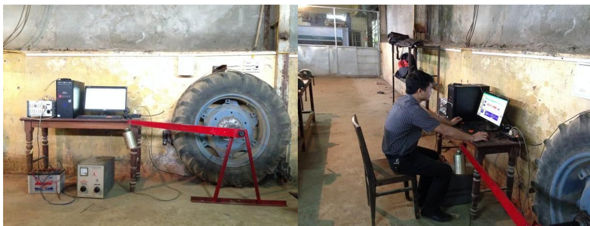
Hiệu chuẩn khâu đo mô men xoắn lên bán trục chủ động
