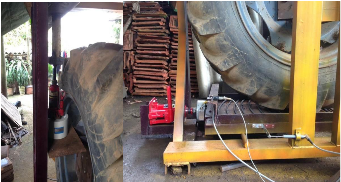
Bố trí tạo lực tải lên trục bánh xe, lực ngang tạo biến dạng tiếp tuyến của lốp, bộ phận đo dịch chuyển của bàn trượt, gia tốc bàn trượt
