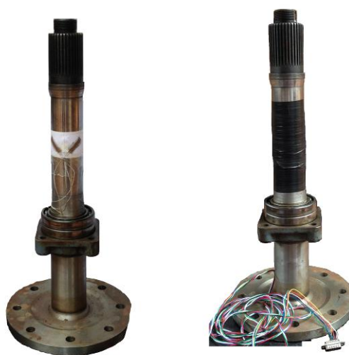
Bán trục chủ động sau khi được chế tạo, dán điện trở
