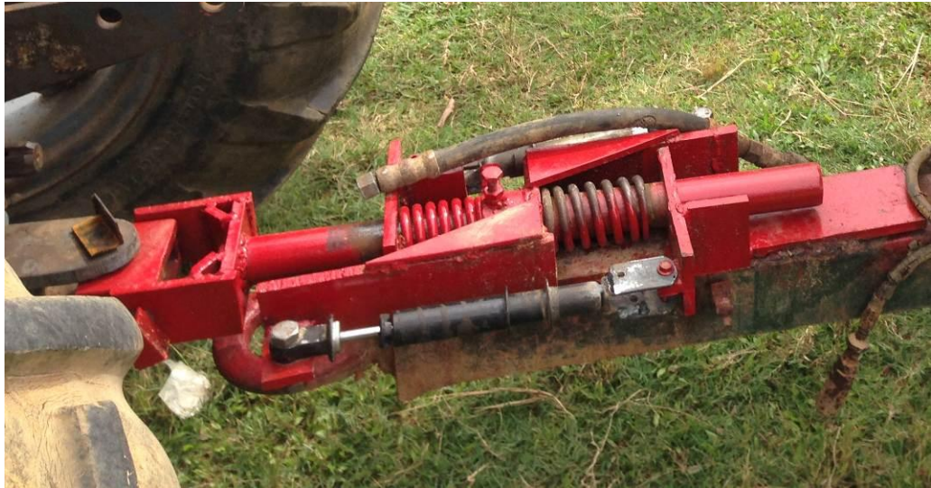
Khớp nối mềm sau khi được thiết kế, chế tạo và lắp ráp lên liên hợp máy
