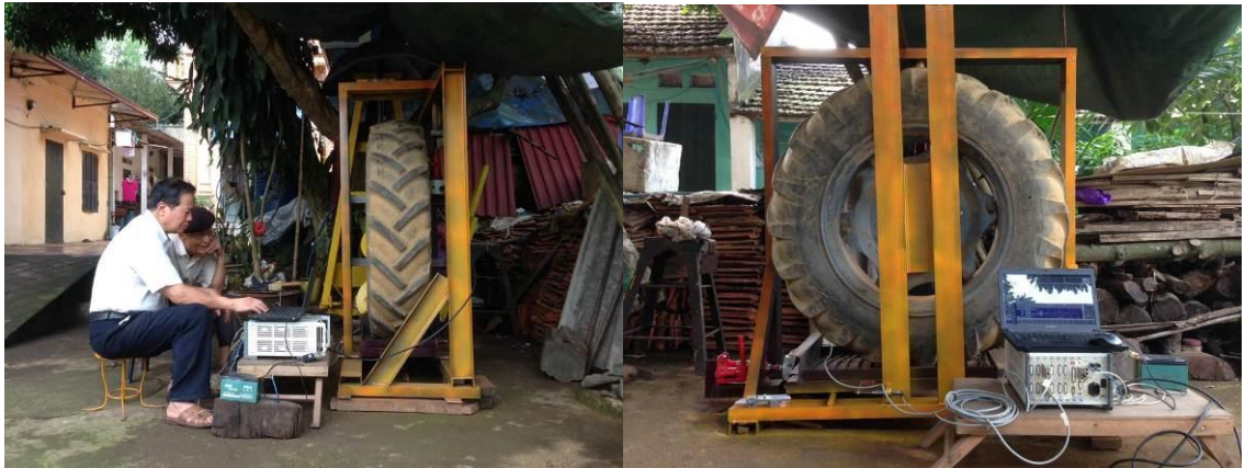
Thí nghiệm xác định độ cứng và hệ số cản của lốp máy kéo
