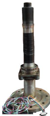
Hình 4.16. Bán trục chủ động được dán tenzo và đấu nối với rắc cắm
