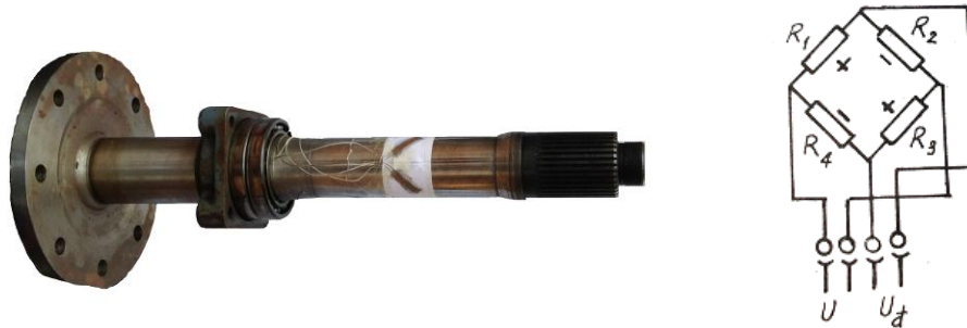
Hình vẽ 4.15. Sơ đồ dán tenzô và mạch đo khi đo mô men xoắn của trục
