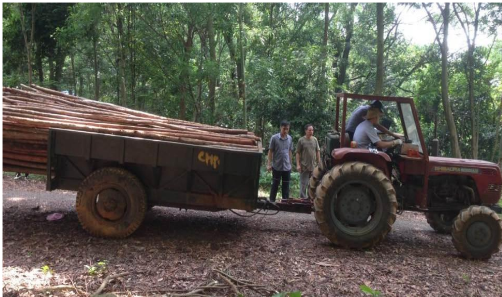
Hình 1.7. Liên hợp máy kéo bốn bánh shibaura 3000A với rơ mooc một trục
