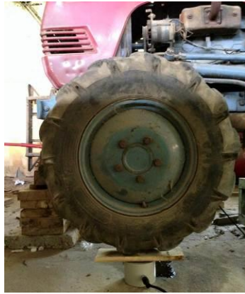
Hình 4.22. Thí nghiệm hiệu chuẩn khâu đo phản lực pháp tuyến lên cầu trước máy kéo
