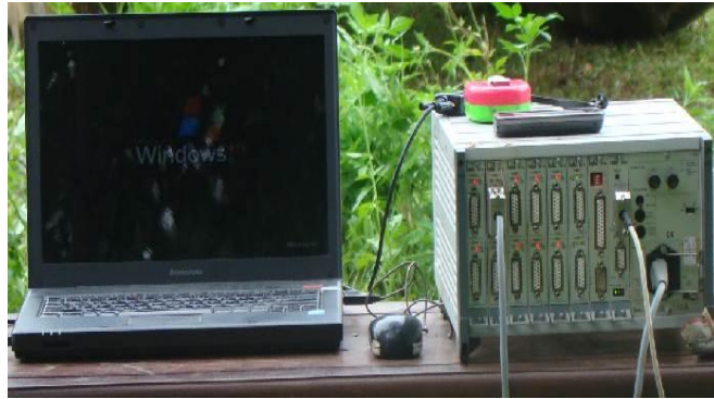
Hình 4.26. Thiết bị thu thập, khuếch đại và hiển thị thông tin đo lường DMC Plus kết nối máy tính
