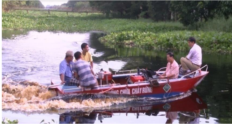
Hình 4.24. Thí nghiệm đo góc nghiêng khi xuồng quay vòng với góc lái lớn nhất
