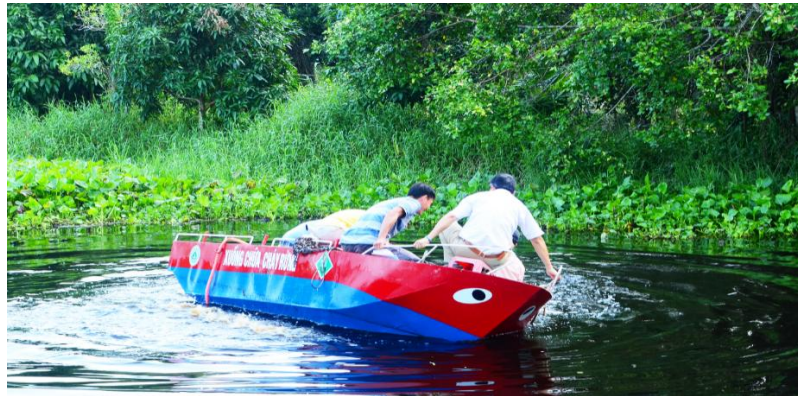
Hình 4.25. Thí nghiệm đo góc nghiêng ngang giới hạn của xuồng chữa cháy
