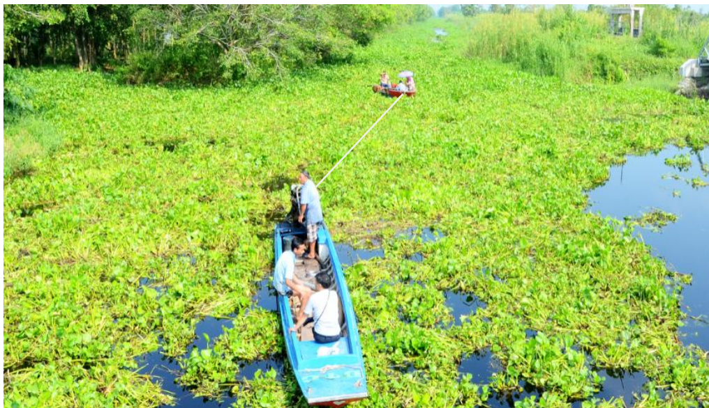
Hình 4.19. Thí nghiệm đo lực cản
