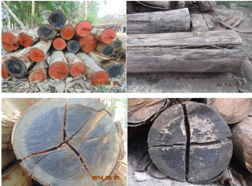
Hình 1.9. Các dạng khuyết tật gỗ Bạch đàn trắng sau khi chặt hạ
